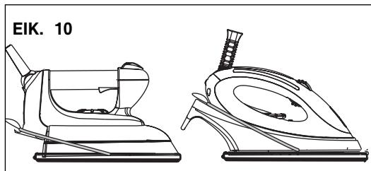
Χρησιμοποιείτε την πρόσθετη πλάκα με την πλάκα του σίδερου σε χαμηλή θερμοκρασία. Ρυθμίστε συνεπώς τη θερμοκρασία της πλάκας με το διακόπτη σε θέση κάτω από τις 3 βούλες αναφοράς (εικ. 5). Μη χρησιμοποιείτε ποτέ την πλάκα στη μέγιστη θερμοκρασία.
