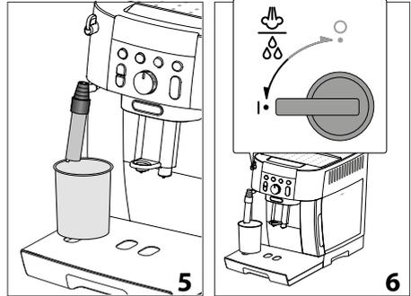
5. Den Ausgabeknopf für Dampf/Heißwasser (A21) auf Position „I“ drehen (Abb. 6): die Getränkeasten blinken und das Gerät gibt Wasser aus dem Milchaufschäumer aus.
