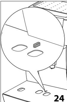
Die Abtropfschale leeren und reinigen, bevor diese Anzeige aus dem Tassenrost hervortritt (A17), andernfalls kann das Wasser über den Rand treten und die Kaffeemaschine, die Aufstellfläche oder den umliegenden Bereich beschädigen.
