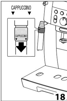
4. Der Milchaufschäumer (A18) kann leicht nach außen gedreht werden, um Gefäße jeder Größe verwenden zu können;
