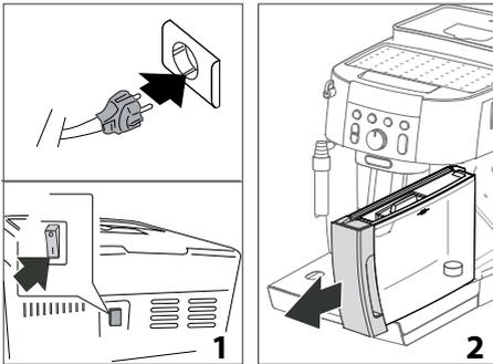
2. An der Bedienblende (B) blinkt die Kontrolllampe : Den Wassertank (A7) herausnehmen (Abb. 2), bis zur Markierungslinie MAX mit frischem Wasser füllen (Abb. 3A) und dann wieder einsetzen (Abb. 3B).
