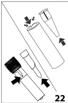
6. Die Düse wieder einsetzen, den Milchaufschäumer wieder auf die Düse setzen, nach oben drücken und nach rechts drehen, bis er einrastet.
