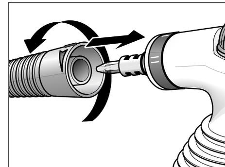
1. Stecken Sie den Verlängerungsschlauch auf die Gelenkdüse. Die Markierung **I** auf dem Schlauch zeigt dabei auf die Markierung **I** am Gerät.
