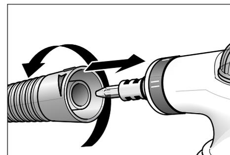
1. Stecken Sie die Strahl- oder die Mehrzweckdüse auf die Gelenkdüse. Die Markierung **I** auf der Düse zeigt dabei auf die Markierung **I** am Gerät.
