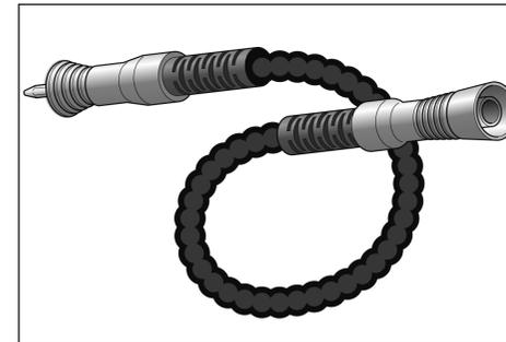
Der Verlängerungsschlauch kann starr oder schwenkbar zwischen Dampfreiniger und Düse oder Bürste befestigt werden. Nachfolgend wird die Befestigung in starrer Position beschrieben. Um den Verlängerungsschlauch schwenkbar zu befestigen, gehen Sie vor wie im Abschnitt „Düse schwenkbar befestigen“ beschrieben.
