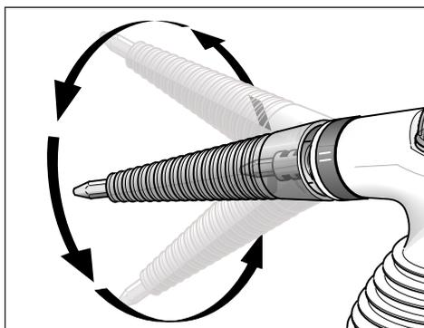
Die Düse ist nun in alle Richtungen schwenkbar.
