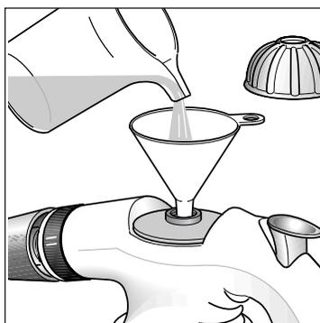
3. Setzen Sie den Trichter in die Öffnung und füllen Sie das Wasser in den Wassertank.
