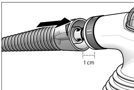
1. Stecken Sie die Strahl- oder die Mehrzweckdüse bis ca. 1 cm auf die Gelenkdüse.
