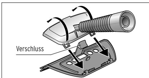
2. Setzen Sie die Mehrzweckdüse so schräg auf den Fensterwischer, dass die beiden hinteren Ösen in die Laschen einhaken.
