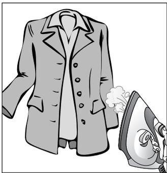
Spannen Sie mit einer Hand den Stoff. Halten Sie Ihre Hand vom Dampf und der Bügelsohle fern. **Es besteht Verbrühungsgefahr!** Halten Sie das Bügeleisen senkrecht, mit der Bügelsohle in einem Abstand von 10 - 15 cm zum Gewebe.
