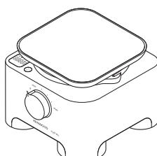
Se si desidera pesare gli ingredienti senza usare la vaschetta o il frullatore, viene fornita una bilancia rimovibile a piatto. Per usare la bilancia, appoggiala sul corpo motore e ruotarla in senso orario per bloccarla in posizione. Ora seguire i punti 2 – 5 della procedura alla voce 'per usare la funzione di pesatura'
