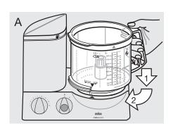
2. 将所需附件(参照每个附件的指示)放上 制作容杯的驱动轴,向下推至底。 3. 将制作容杯盖(7)盖上,盖子上的箭头对准容杯上的箭头。然后顺时针向旋转盖子,前端卡入马达座(1)开口处,直到听到响声,卡入位置为止(B)。
