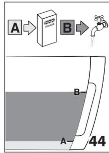
7、倒入除垢液到水箱底部标注“A”的位置(大约100毫升)(如图44)，然后加入1升的水至“B”的位置(如图44)，然后将水箱装回机器；
