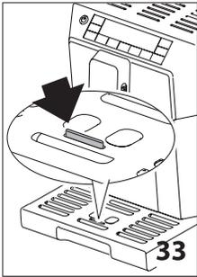
滴水盘(A12)配有一个红色的水位指示浮标(A13)(如图33)。该水位指示浮标从托盘中浮出来前，必须清空滴水盘，并清洗。不然，水会从滴水盘的边缘溢出来，之后会渗透到机器内部或四周，这将会损坏咖啡机。
