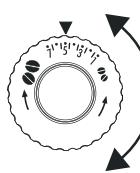
如果咖啡的流出速度太慢或根本不出咖啡，请顺时针向“7”的方向转动一格。若要求油脂丰富且厚重的咖啡，请逆时针向“1”的方向转动一格（每次转动不要超过一格，否则咖啡会一滴一滴滴下来）。至少制作两杯咖啡以后，调节研磨的效果才会显现出来。若调节后仍未达到理想的效果，可将研磨调节旋钮再转动一格。
