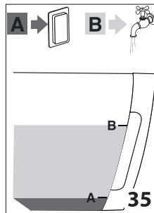
3、倒入除垢液 (D3) 到水箱底部标注“A”的位置(大约100毫升)(如图35A)，然后加入1升的水至“B”的位置(如图35B)，然后将水箱装回机器，插入热水出口 (D6)；在热水出口 (D6) 的下方放置一个最小容积为1.8升的容器。
