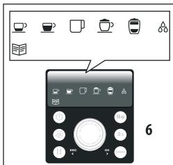
3. 按下 **BREW** 按钮 (C6) 确认：指示灯闪烁 (如图6) 表示本机已重设出厂设置。
