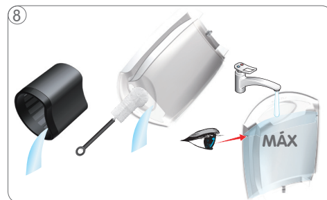
Vaciar el depósito de cápsulas. Enjuagar y limpiar a fondo el depósito de agua. Llenar el depósito de agua con agua potable hasta el nivel máx.
