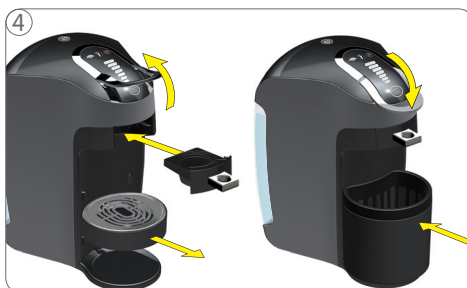
Abrir la palanca y comprobar que el soporte de la cápsula esté vacío. Cerrar la manija de bloqueo de nuevo. Colocar el depósito de cápsulas debajo de la salida.
