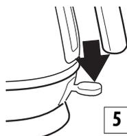
Spotrebič sa vypne a tlačidlo vypínača sa automaticky prepne do polohy OFF.
