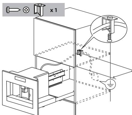
Umiestnite prístroj do vodičích líst, pričom sa uistite, že čapy sú dobre zasunuté a upevnite ho dodanými skrutkami.
