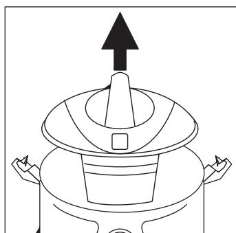
ارفع وحدة المحرك مستخدما المقبض الخاص ، بعد الاكسسوارات الموجودة داخل جسم الجهاز ، وزود الجهاز بالمكونات اللازمة وذلك حسب نوع التنظيف المراد القيام به.
