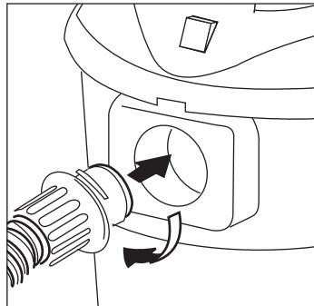
عليك بربط الانبوب المرن بادخاله في فتحة شفط الجهاز ، وذلك بادارة فتحة الانبوب باتجاه دوران عقارب الساعة حتى يتم تثبيته.
