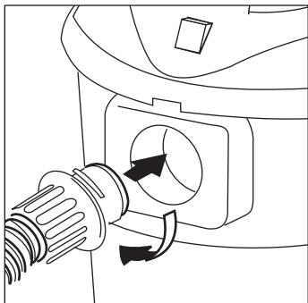
Подключите гибкий шланг к всасывающему отверстию прибора, поворачивая горловину шланга по часовой стрелке до момента зацепления.
