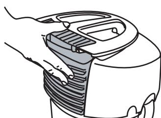
Периодически приподнимайте верхнюю часть прибора и поворачивайте ее, чтобы поплавок внутри корзины защиты мотора свободно двигался.
