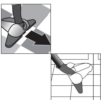
**Насадка для деликатных полов для щетки "Explora" (только для определенных моделей):** насадка покрыта войлоком, что позволяет использовать ее на деликатных полах – паркете и мраморе с покрытием.
