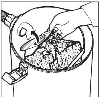
Мешок для сбора пыли устанавливается в баке, его картонный рукав одевается на внутреннюю часть всасывающего отверстия и сдвигается до упора.
