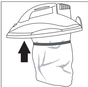
Убедитесь, что мешок для защиты мотора одет на корзину защиты мотора. Бумажный фильтр крепится обычной круглой резинкой.
