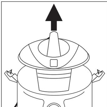
Поднимите мотор, пользуясь ручкой, достаньте насадки из корпуса и приготовьте компоненты необходимые для уборки, которую вы хотите произвести.
