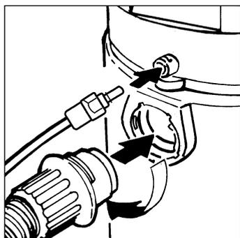
Подсоединить гибкий шланг к всасывающей горловине прибора, поворачивая до упора втулку гибкого шланга по часовой стрелке. Даже если она при всасывании пылесосом не нужна, подсоединить трубочку подачи жидкостей (5) к сборному баку, чтобы она не мешала работать.
