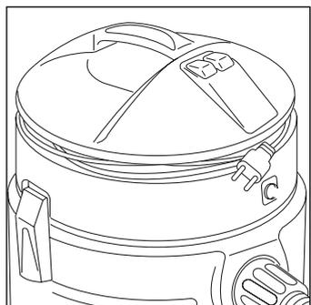
Перед тем, как поставить прибор на свое место, разместить принадлежности в сборном баке и обмотать кабель вокруг специально предусмотренного углубления на головке прибора.
