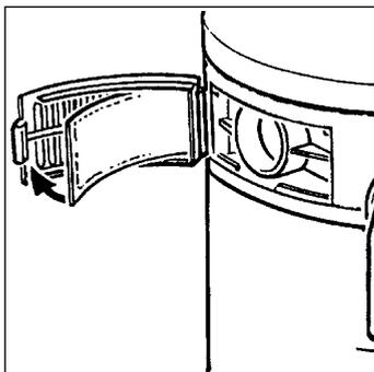
Периодически заменять воздушный фильтр, расположенный внутри дверцы моторного блока.
