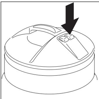
Оборудовав пылесос гибким шлангом и нужной насадкой, вставить вилку в розетку и нажать на главный выключатель. Для отключения прибора нажать еще раз на главный выключатель.
