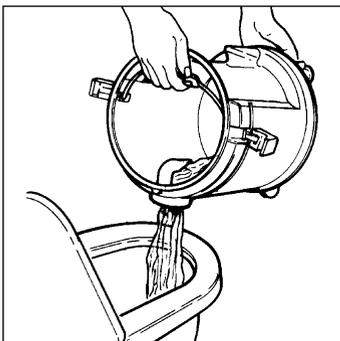
**Внимание:** сборный бак имеет емкость 8 л. В случае если объем отсосанных жидкостей превысит емкость сборного бака, специально к этому предусмотренное устройство отключит отсасывание, а скорость оборотов двигателя увеличится. При этом надо выключить прибор, снять вилку из розетки и опорожнить сборный бак.
