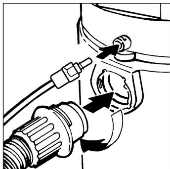
Сцепить моторный блок со сборным баком, подсоединить гибкий шланг к всасывающей горловине прибора, поворачивая до упора втулку гибкого шланга по часовой стрелке.
