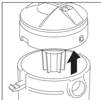
Поднять моторный блок с помощью ручки, вынуть принадлежности из сборного бака и оснастить прибор нужными для выполняемой операции насадками.
