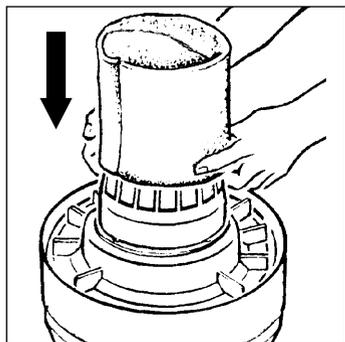
Отцепить моторный блок, потянув блокировочные защелки наружу (как уже указано в пункт 1. "Как подготовить прибор к использованию"). Надеть на предохранительную клетку двигателя фильтр из полиуретана для отсасывания жидкостей.
