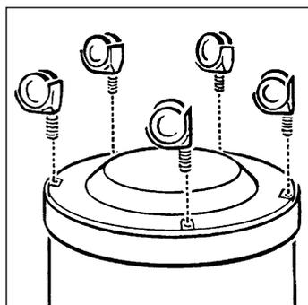
Опрокинуть прибор и установить поставленные в комплекте с прибором колеса, вталкивая их до упора в отверстия, к этому предназначенные, под сборным баком.
