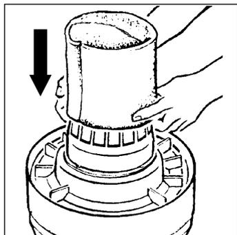
Отцепить моторный блок, потянув блокировочные защелки наружу (как уже указано в пункт 1. "Как подготовить прибор к использованию"). Надеть на предохранительную клетку двигателя фильтр из полиуретана для отсасывания жидкостей (19). Проверить, чтобы не были установлены ни бумажный (20) и (21).
