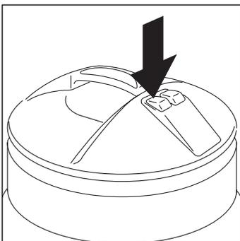
Оборудовав пылесос гибким шлангом и нужной насадкой, вставить вилку в розетку и нажать на главный выключатель (3).
