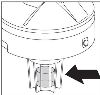
Проверять периодически, чтобы поплавок за предохранительной клетью двигателя свободно двигался в своем гнезде.
