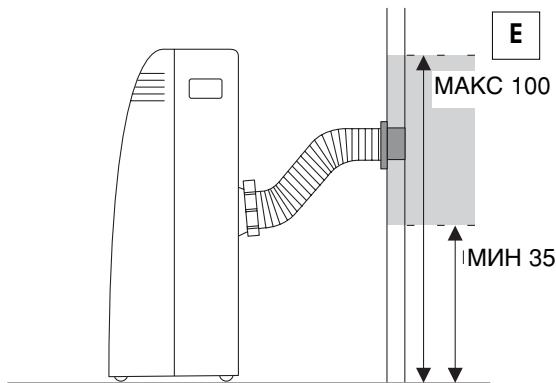
Если труба 12 не вставлена в отверстие, оно может быть закрыто при помоши пробки фланца 11.
