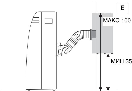
Если труба 13 не вставлена в отверстие, оно может быть закрыто при помощи пробки фланца 12.
