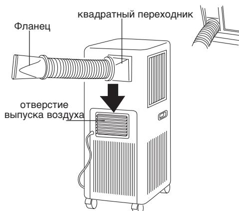
Правильная установка на стене: высота отверстия от пола должна быть между 40 и 130 см.
