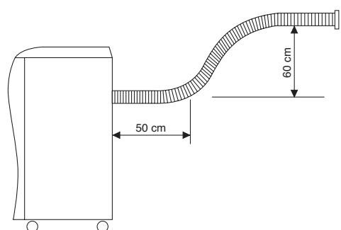
Неправильная схема установки (слишком большой перегиб может привести к неисправности кондиционера).
