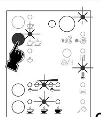
Замачивание предназначено для извлечения всего аромата из молотого кофе и благодаря этому для получения наивысшего качества. (Замачивание не происходит при приготовлении очень больших порций кофе).
