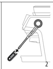
2. Подождите, пока насадка выпуска пара остынет, и очистите отверстие сопла с помощью иглы для очистки (C12).
