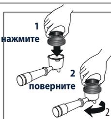
2. Вставьте мерную воронку (C4) в держатель фильтра: 1 нажмите и 2 поверните до фиксации.
