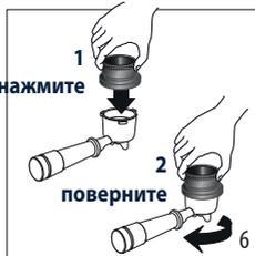
6. Вставьте мерную воронку (C4) в держатель фильтра: 1 нажмите и 2 поверните до фиксации. Нажмите «>» на дисплее.
