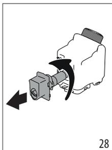
3. Снимите соединитель (E3), повернув его против часовой стрелки, и вытащите его не прилагая чрезмерного усилия (рис. 28).
