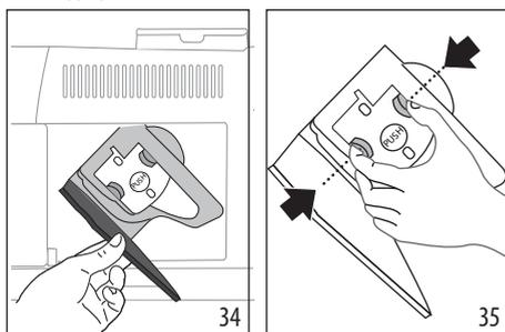
5. Промойте заварочный узел под проточной водой без моющих средств. Если загрязнения стойкие, оставьте заварочный узел в питьевой воде на 5 минут, а затем используйте кисточку для удаления остатков грязи.
