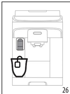
2. Поставьте чашку под узел подачи горячей воды (рис. 26) (как можно ближе, чтобы избежать разбрызгивания).
