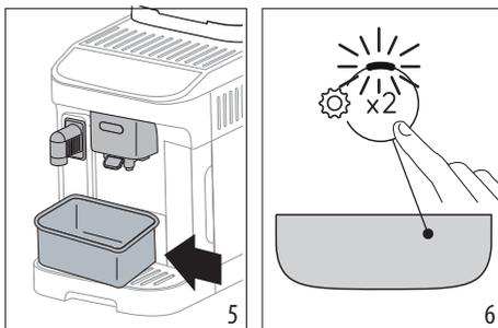
5. Нажмите кнопку
