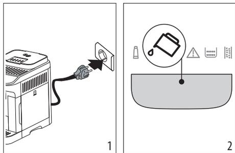
2. На контрольной панели (B) загорится индикатор
