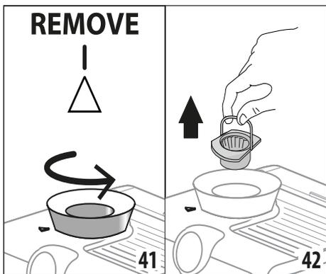
5. Снимите верхнюю часть жернова за специальную ручку (рис. 42).
