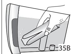
4. Достаньте бачок (A9) из машины и заполните его водой.
