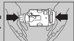
**ПРИМЕЧАНИЕ 3:** если после этого заварочный узел трудно вставить, положите его, закройте дверцу для обслуживания, выньте и вставьте на место шнур электропитания. Дождитесь, когда дисплей выключится, откройте дверцу для ухода и вставьте заварочный узел.
