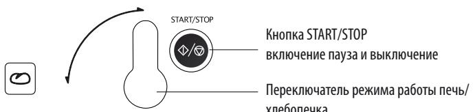
**i** Примечание: Для использования аппарата в качестве печи, повернуть переключатель режима печь/хлебопечка в позицию Значок загорится.
