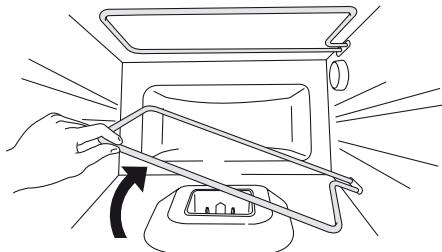
По окончании очистки, установить на место нагревательный элемент.
