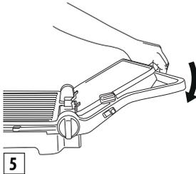
Если ручка поднимается до того, как сдвинут блокировочный рычаг, уменьшите нажатие на шарнир и операция открытия будет производиться легче. Прибор может быть использован, как гриль-барбекю для приготовления гамбургеров, бифштексов, курицы и рыбы. Режим гриль-барбекю позволяет использовать прибор очень гибко. Плиты находятся в открытом положении, и в распоряжении появляется двойная поверхность для жарки.
