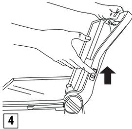
Сдвиньте назад рычаг, чтобы полностью перевернуть крышку в развернутое состояние (рис. 5).
