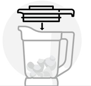
Coloque a tampa na parte superior do jarro e prima com força até que fique bloqueada no lugar. Coloque o tampão ventilado na abertura da tampa e, depois, pressione para baixo e rode-o até que fique bloqueado no lugar.
