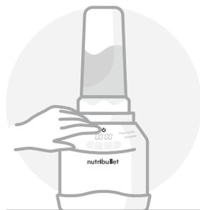
Quando tiver atingido a consistência desejada, desligue o aparelho premindo o botão . A unidade entrará em modo de repouso. O temporizador fica a zeros e o **painel de controle** permanece iluminado. Prima novamente o botão para desligar completamente o aparelho.
