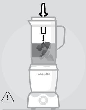
**CUIDADO:** Não utilize qualquer aparelho ou utensílio que não seja o empurrador para empurrar os ingredientes para a lâmina. O empurrador foi especificamente concebido para não entrar em contacto com a lâmina. Espátulas, colheres e outros utensílios são suficientemente compridos para chegar à lâmina, o que pode resultar em danos na máquina, danos materiais e/ou possíveis ferimentos.
