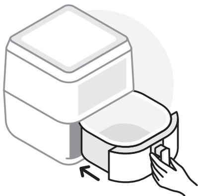
**2** Segurando-a pela pega, insira a gaveta de cozimento na base. Certifique-se de que a fritadeira de ar quente está devidamente montada com a **gaveta de cozimento** completamente inserida na **base**.
