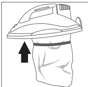
Certifique-se de que o saco de papel de protecção do motor está inserido no cesto de protecção do motor.
