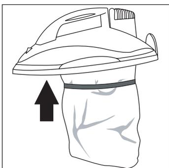
Certifique-se de que o saco de papel de protecção do motor está inserido no cesto de protecção do motor. O filtro de papel deve ser fixado com um elástico normal.
