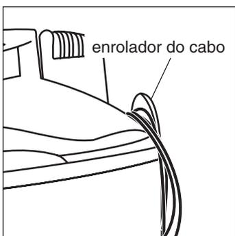
Para arrumar o aparelho, introduza os acessórios no suporte porta-acessórios e coloque o cabo à volta do enrolador do cabo.
