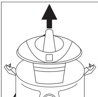
Levante a unidade do motor, utilizando a respectiva pega, retire os acessórios do interior do tambor e monte os componentes necessários conforme o tipo de limpeza a efectuar.
