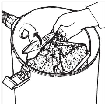
O saco recolhedor de pó deve ser montado dentro do tambor; o colar de papelão deve ser enfiado e empurrado até o fundo em torno da parte interna da entrada de aspiração.
