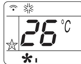
*La funzione notte consente di mantenere l'ambiente alla temperatura ottimale evitando un eccessivo innalzamento o abbassamento della temperatura con funzionamento silenzioso. Il flusso d'aria diminuisce, mentre la temperatura dell'ambiente varia gradualmente seguendo le esigenze di benessere: aumenta di 1°C dopo 60 minuti e di 2°C dopo 2 ore (desliga-se ao fim de 8 horas).*
