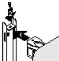
Como alternativa para instalações provisórias, é possível levantar a unidade externa conforme indicado na figura. Neste caso, serão utilizadas as correias [11], que foram entregues com o aparelho, enganchadas nos olhais [12]; antes de inserir os olhais, retirar as tampas em borracha.
