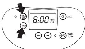
6. prima a tecla TIMER (7); surge novamente a hora do dia e os minutos de cozedura da massa. Prima, de seguida, a tecla TIMER ON (8) para activar a programação; acende-se o respectivo led (9) relativo à cozedura programada.
