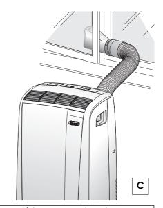
Limite ao mínimo o comprimento e as curvas dos tubos de ar, evitando torcêlos.
