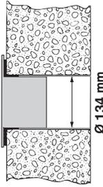
na parede: é aconselhável isolar a seção da parede com um material isolante apropriado
