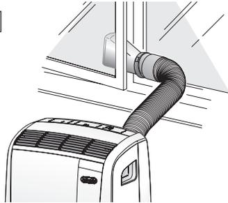
**!** **Atenção!** Limite ao mínimo o comprimento e as curvas dos tubos de ar, evitando torcê-los.
