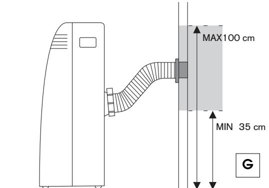
Se o tubo **12** não estiver encaixado, o orifício pode ser fechado com a tampa da flange **11**.
