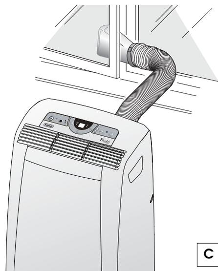
Limite ao mínimo o comprimento e as curvas dos tubos de ar, evitando torções.
