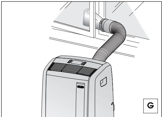
Limite ao mínimo o comprimento e as curvas dos tubos de ar, evitando torcê-los.
