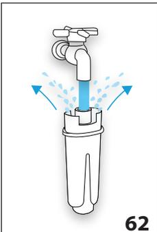
6. "DEIXE CORRER ÁGUA PELOS ORIFÍCIOS ATÉ ELA SAIR PELAS FENDAS" (fig. 62): Para ativar o filtro, fazer escorrer a água da torneira no furo do filtro como indicado na figura até que a água saia pelas aberturas laterais por mais de um minuto. Prima "▶ NEXT";
