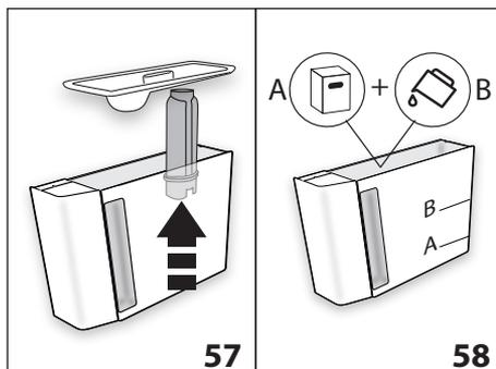
5. "DEITE DESCALCIFICANTE (NÍVEL A) E ÁGUA (ATÉ AO NÍVEL B)" (fig. 58); Deitar no reservatório de água o descalcificante até ao nível A (que corresponde a uma embalagem de 100 ml) impresso ao lado do reservatório; e então adicionar água (um litro) até atingir o nível B; recolocar no lugar o reservatório de água. Prima "➡️ NEXT";
