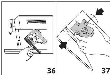
4. Pressionar para dentro as duas teclas coloridas de desengate e ao mesmo tempo extrair o infusor para o lado de fora (fig. 37).
