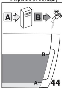
7. Deitar no depósito de água o descalcificante até ao nível **A** (que corresponde a uma embalagem de 100 ml) impresso ao lado do depósito (fig. 36) e então adicionar água (um litro) até atingir o nível **B** (fig. 36); recolocar no lugar o reservatório de água.
