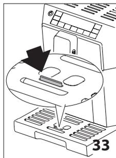
O tabuleiro de recolha de pingos (A12) é dotado de um indicador flutuante (A13 na cor vermelha) do nível da água coletada (fig. 33). Antes que este indicador comece a projetar-se na superfície para apoiar chávenas, é necessário esvaziar o tabuleiro e limpá-lo, caso contrário a água pode transbordar e danificar a máquina, ao plano de apoio ou à zona circunstante.
