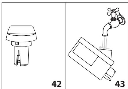
5. Enxaguar o interior da sede do manipulô de regulação da espuma com água corrente (fig. 43).
