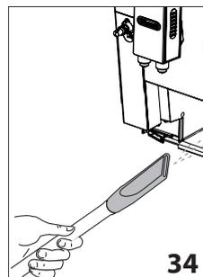
1. Inspeccionar periodicamente (cerca de uma vez por mês) se o interior da máquina (acessível quando for extraído o tabuleiro de recolha de pingos - A12) está sujo. Se necessário, remover os depósitos de cafés com o pincel (C5) fornecido e uma esponja.
