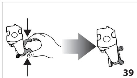
8. Uma vez inserido, certificar-se que as duas teclas coloridas tenham desengatado para fora (fig. 40);
