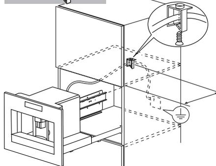
Coloque a máquina nas calhas, certificando-se de que os pinos engatam corretamente nas respectivas posições antes de fixar com os parafusos fornecidos.
