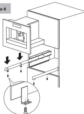
Se for necessário ajustar o alinhamento da máquina, coloque os espaçadores fornecidos em baixo ou de lado para suporte.
