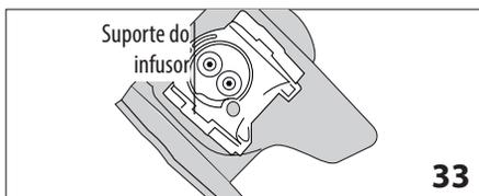
7. Depois da limpeza, introduza novamente o infusor, inserindo-o no suporte (fig. 33); em seguida pressione na escrita **PUSH** (empurrar) até ouvir o clique de encaixe.
