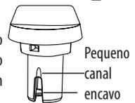
5. Lavar as partes internas do compartimento do manípulo de regulagem de espuma com água corrente (ver figura).
