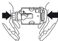
Se infusor é difícil de inserir, é necessário (antes da inserção) colocá-lo na dimensão correcta pressionando-o com força contemporaneamente pela parte inferior e superior como indicado
