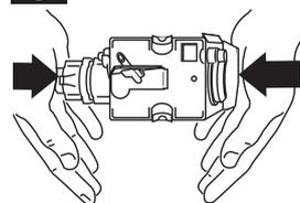
Se o infusor for difícil de inserir, é necessário (antes da inserção) colocá-lo na dimensão adequada pressionando as duas alavancas como indicado na figura.
