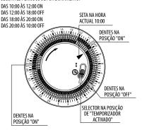
Para utilizar o aparelho independentemente da programação do temporizador, coloque o selector na posição "I".
